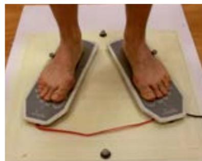
Figure 5 : « Sabots » dynamométriques (Feetest de Technoconcept, Mane, France) constitués de quatre plateformes de force, une sous chaque avant et arrière-pieds. Les pieds du sujet sont disposés avec 17 cm d'écart entre le milieu de la partie postérieure des talons, et un angle de 14° d'ouverture des pieds vers l'avant (axe passant par le milieu du talon et le 1<sup>er</sup> métatarsien).
